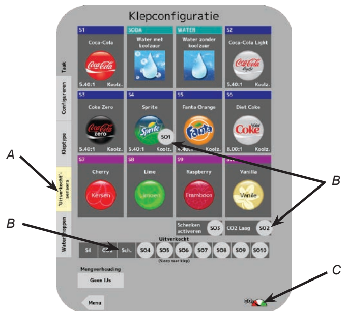
A. Tabblad 'Uitverkocht'-sensors B. 'Uitverkocht'-sensors 1-10 C. Indicatie lage CO 2 -druk
