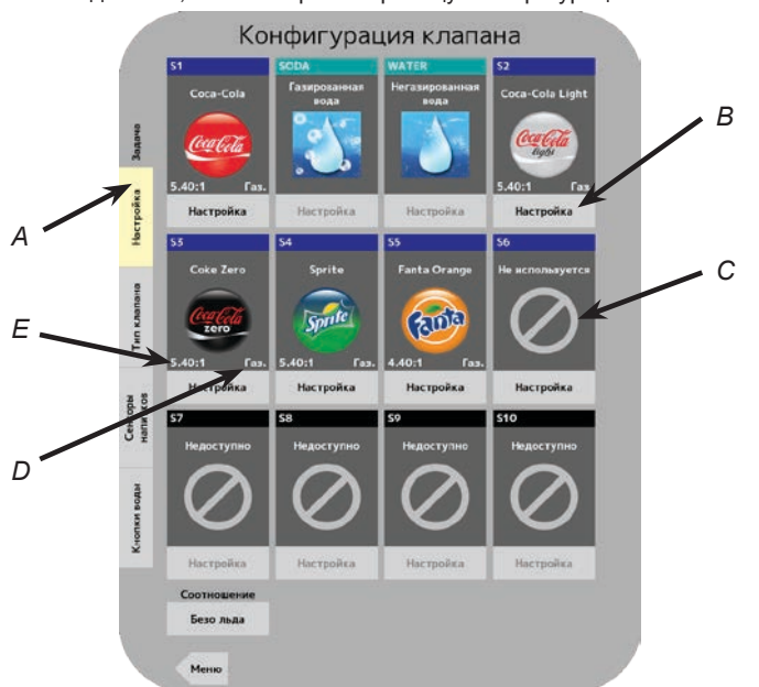
A. Вкладка «Настройка» B. Кнопка «Настройка» C. Активированный модуль D. Тип воды брендов E. Соотношение брендов
